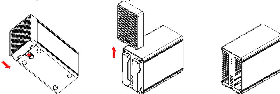
2. Instale los discos duros como se indica en la siguiente ilustración, con las superficies superiores, en las que se encuentran las etiquetas, orientadas una hacia la otra. Presione ligeramente las unidades para encajarlas y vuelva a instalar el panel frontal.
